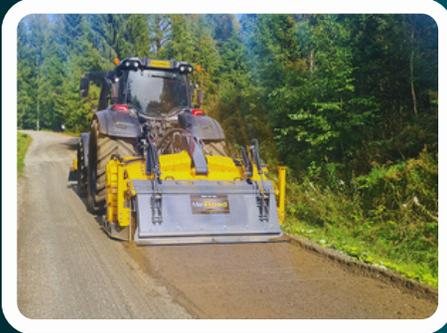
Unabhängig gesteuerte hydraulische Seitenkufen ermöglichen eine einfache Tiefenkontrolle und das genaue eintauchen des Rotors in Asphaltdecken. Mit einer grossvolumigen Rotorkammer, einer hydraulisch verstellbaren Gegenschneide und dem hinteren Kornsieb kann, je nach Anforderung, eine optimale Körnung erreicht werden.
